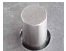
Corte de orificio de 25 mm (1/2 pulg.) sin tecnología True Hole con plasma HPRXD
